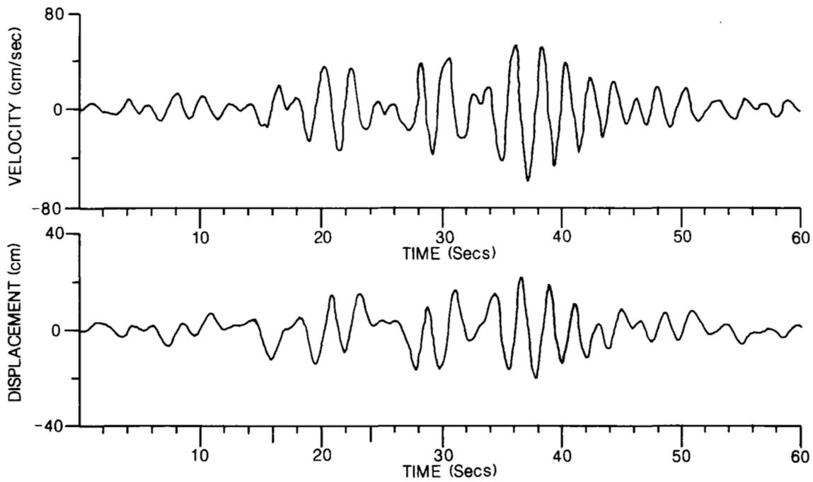
(b) EW Horizontal - Velocity & Displacement
